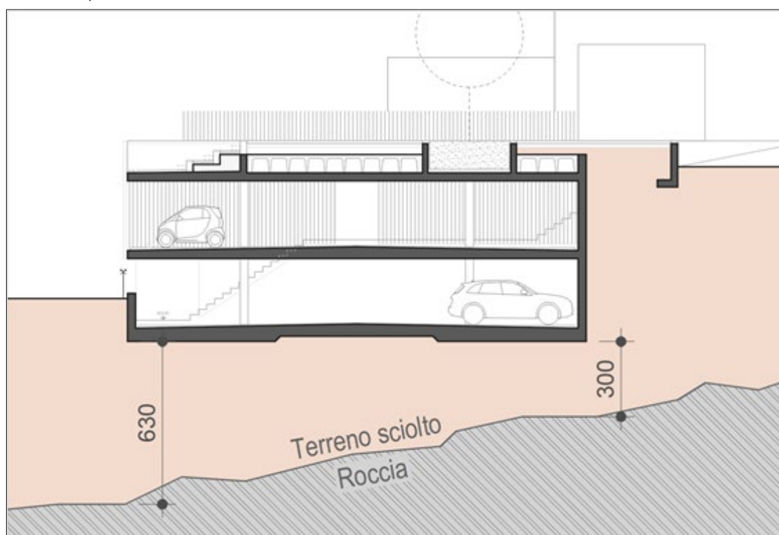
Fig. 5: Sezione stratigrafia terreno
